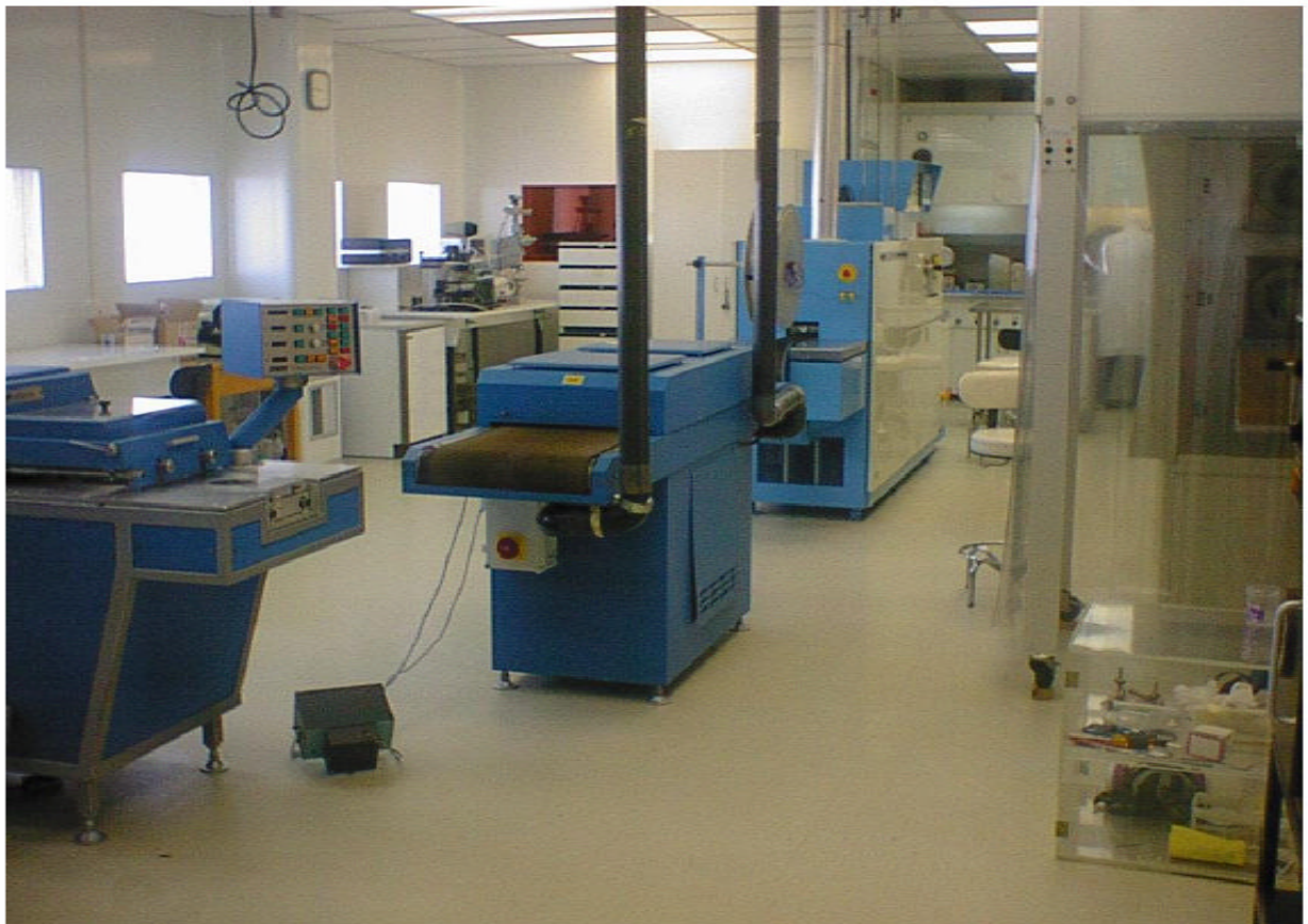
Fig II.10 : Métallisation par sérigraphie
