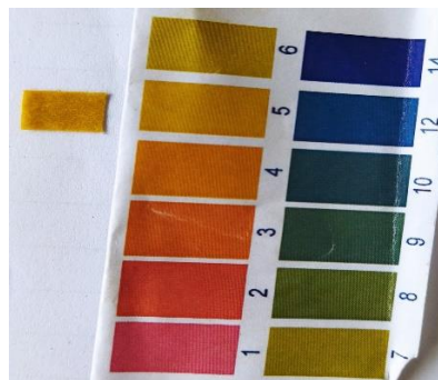
Figure 17 : Méthode de détermination du pH des HE (Originale)
