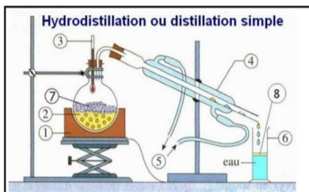
1-Chauffe ballon; 2- Ballon; 3-Thermomètre; 4-Réfrigérant; 5-Entrée et sortie d'eau; 6-Erlenmeyer; 7- Matière à extraire l'essence; 8- couche d'HE.
