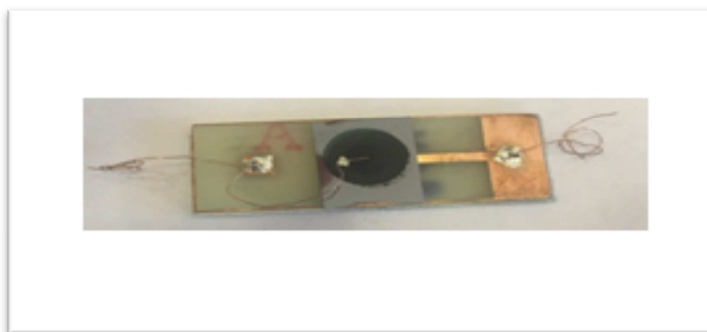
Figure II-9 : Structure utilisée pour la détection.
