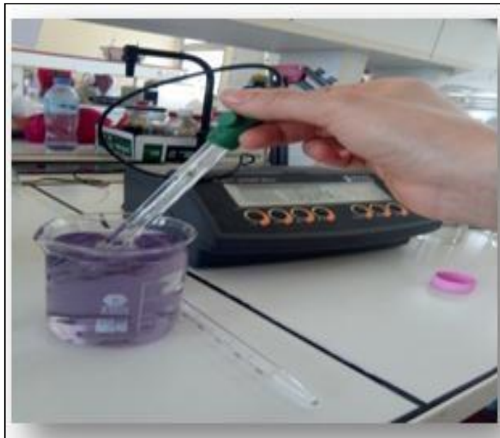
Figure II. 19 : Mesure de pH de la solution colorée.
