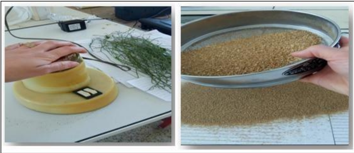
Figure II. 3 : Broyage et tamisage de la matière végétale.
