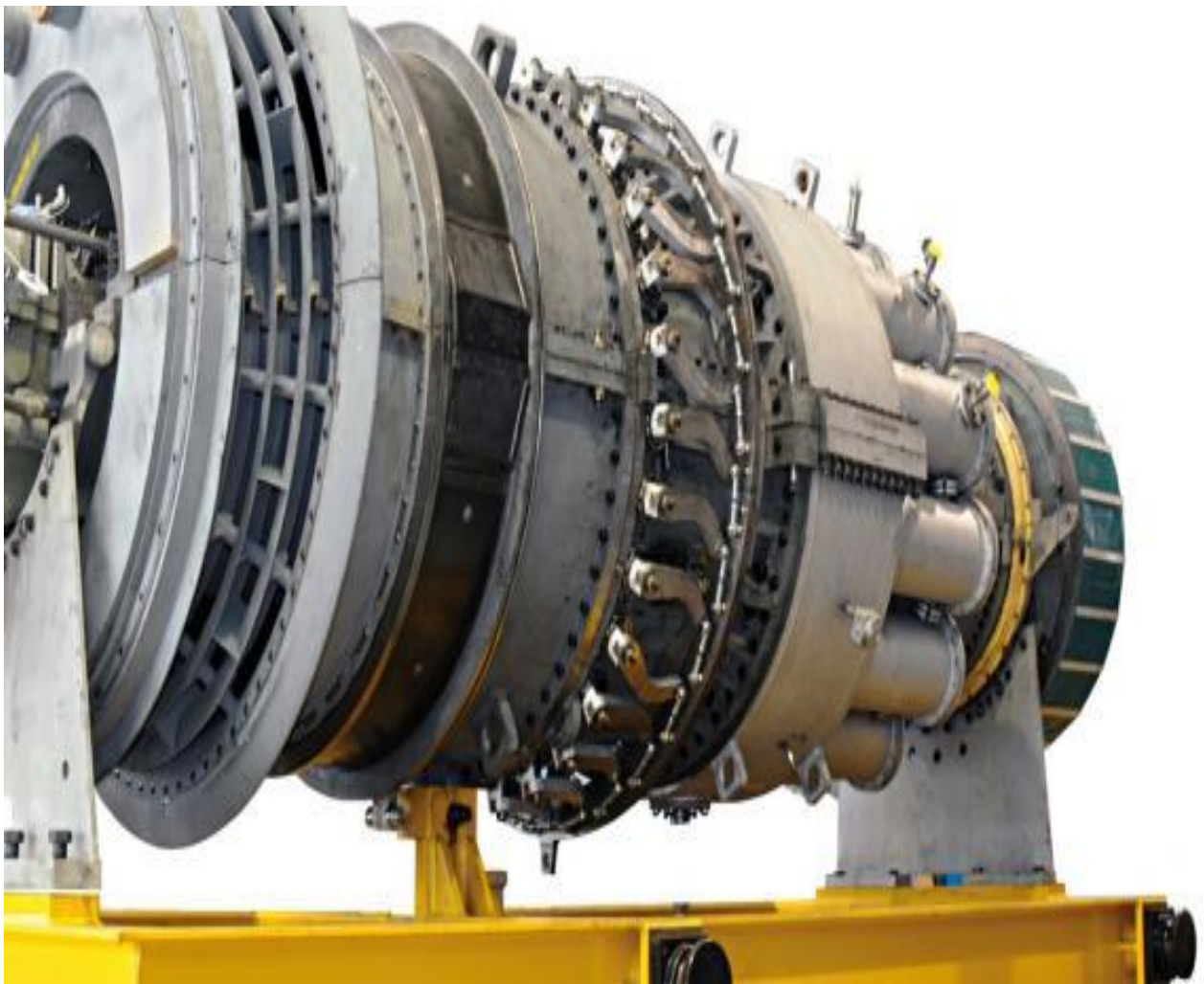
Figure 1.3 : Turbine à gaz MS5002C.
