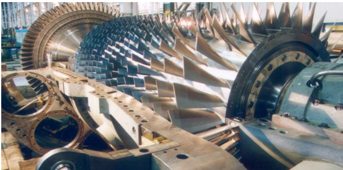
Figure 1.9 : Rotor de compresseur (rotor HP).
