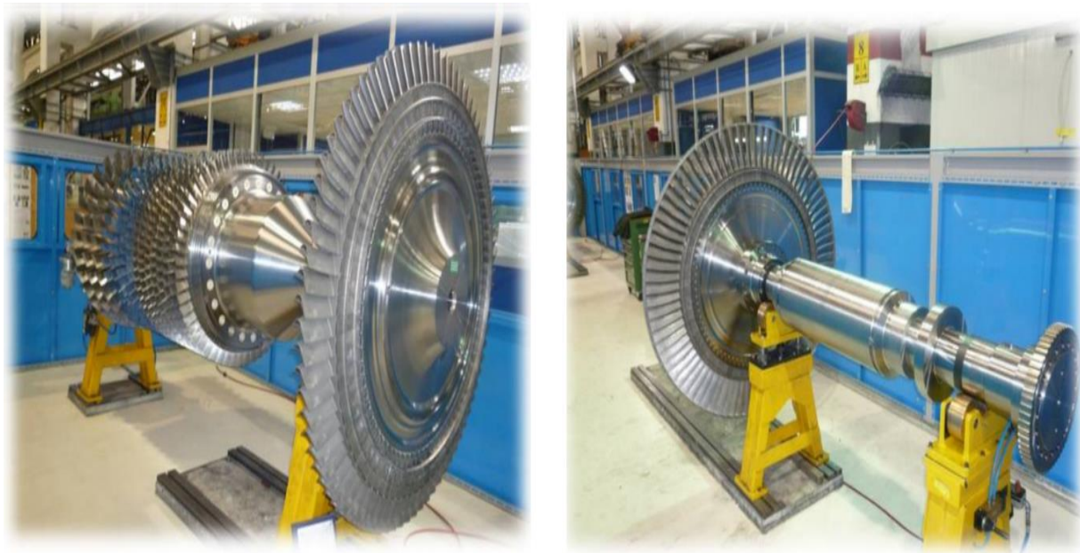
Figure 1.17: Roue de turbine HP et BP.
