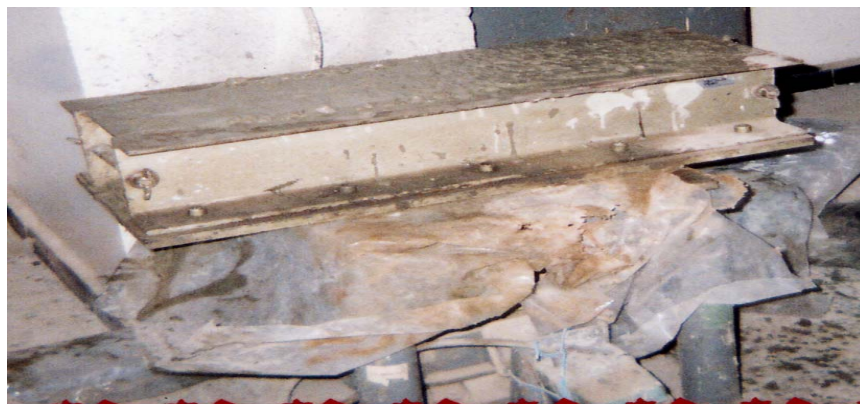
B - Vibration des moules prismatiques
