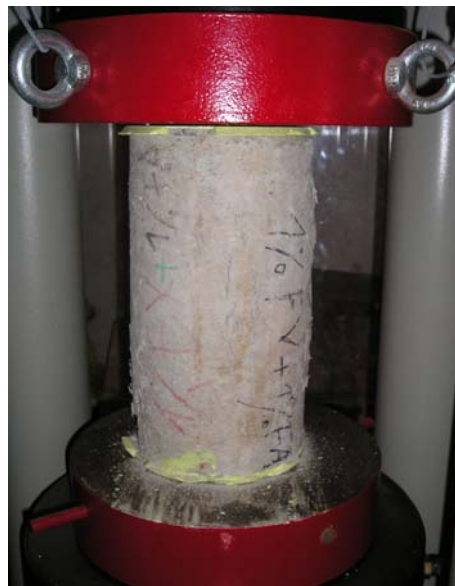
Figure III.12. Mode d'essai et rupture de l'éprouvette
