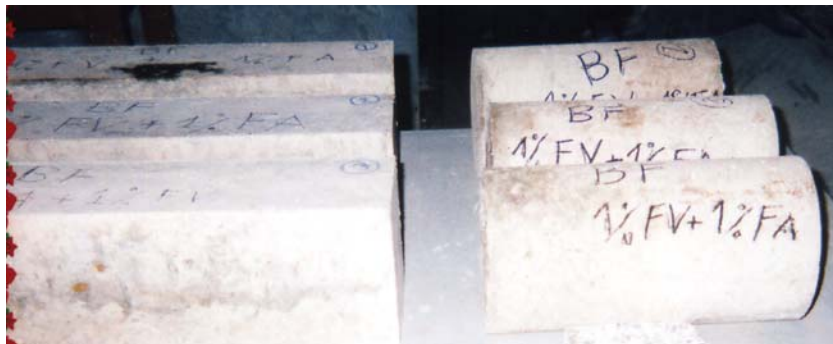
Figure II.8. Béton composite BCI (1 % Fv + 1 % Fa)
