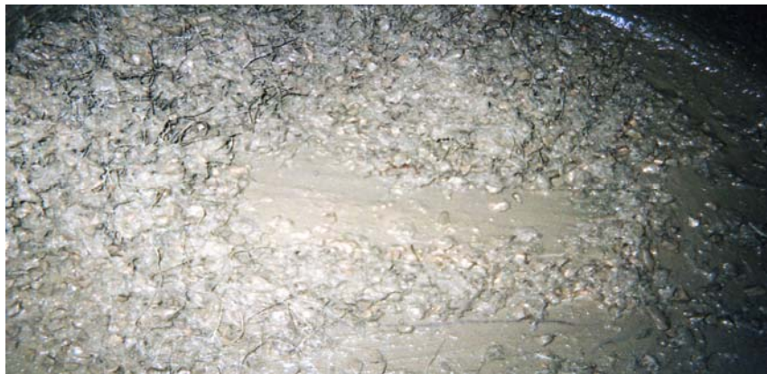
B- Ajout de fibres d'acier
