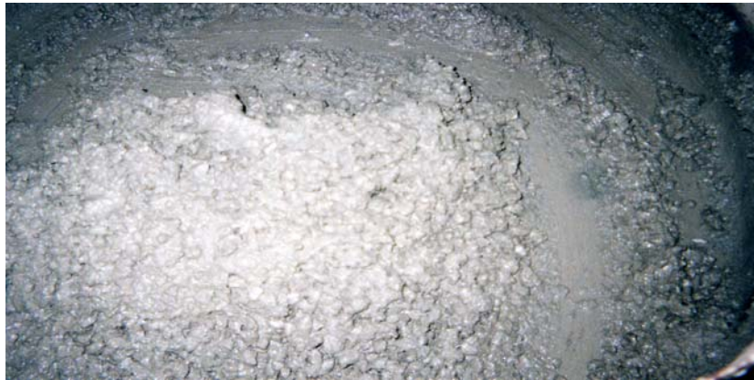
A- Malaxage du béton sans fibres
