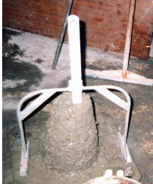
Figure II.3. Mesure de l'affaissement à l'aide du Cône d'ABRAMS
