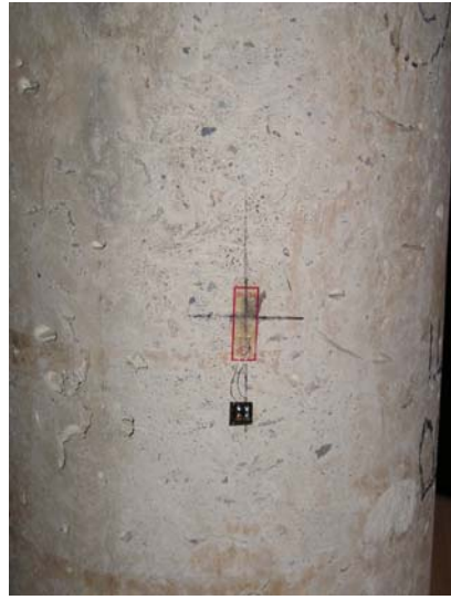
Figure III.11.b. Collage de la jauge
