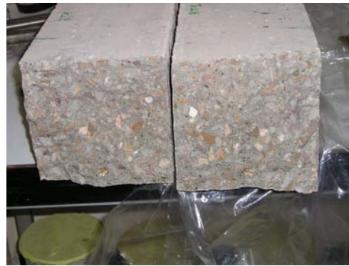
Figure III.3.b. Structure interne (Répartition granulaire)
