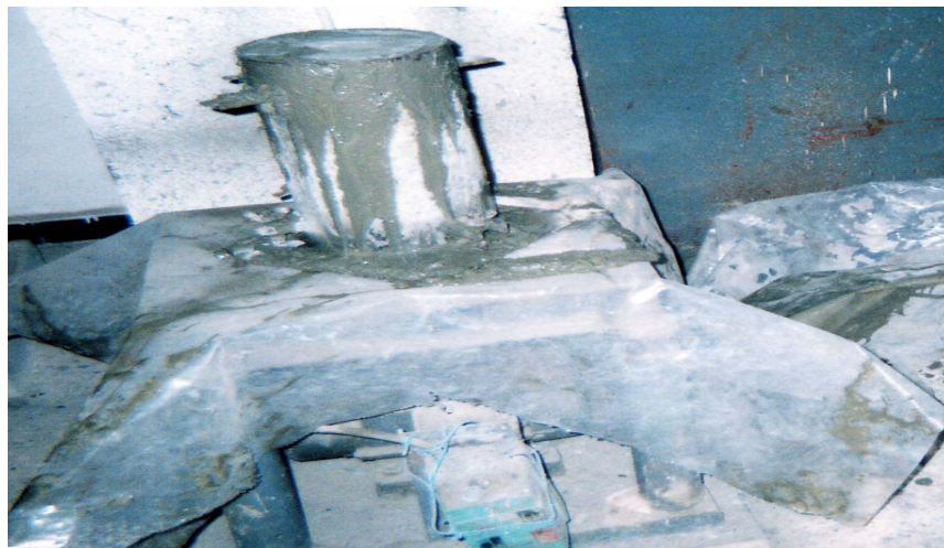
C - Vibration des moules cylindriques
