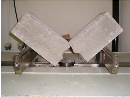
Figure III.3.a. Rupture du béton témoin (Rupture fragile à mi-portée)
