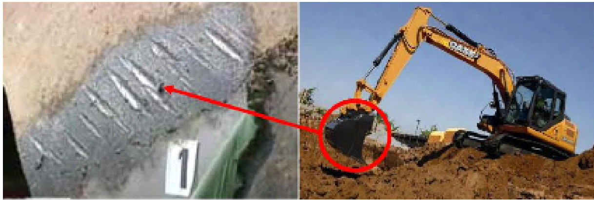
Figure III.2 : Exemple de pipeline contenant une entaille
