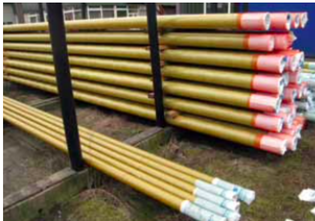
Figure VI.2 : Pipeline en fibre de verre en stock
