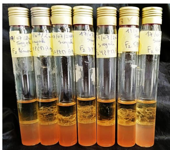
Figure 23 : Aspect des émulsions formées en présence d'AgNO 3 à différentes concentrations pour la souche F2.
