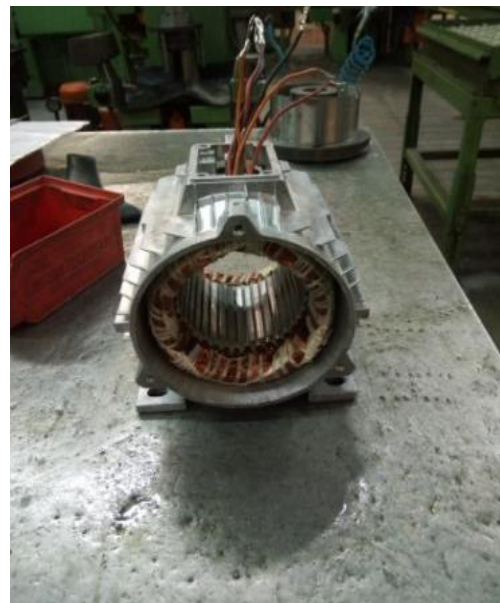
Figure I. 28 : stator bobiné monté dans une carcasse
