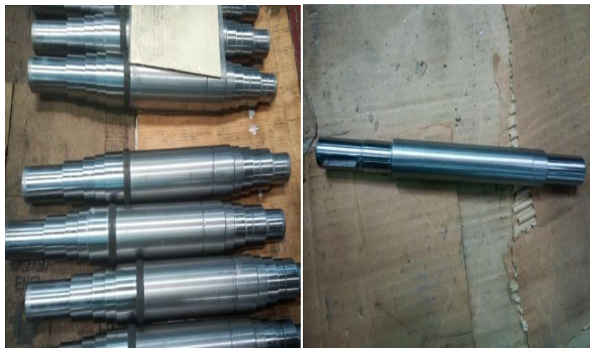
Figure I. 10 : Arbre d'un moteur électrique après usinage
