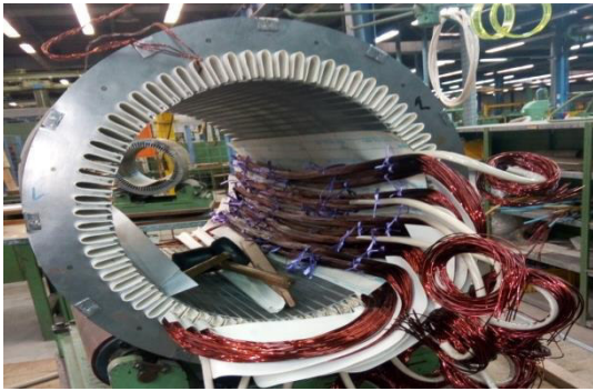
Figure I. 24 : Stator avec caniveau d'encoches isolées
