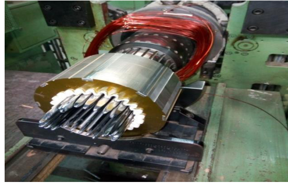
Figure I. 25 : Insertion automatique dans les encoches d'un stator
