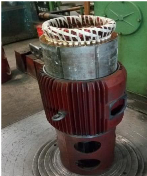
Figure I. 27 : Pré montage du stator dans la carcasse.
