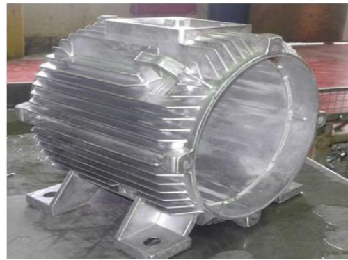
Figure I. 20 : carcasse métal coulé (Aluminium)
