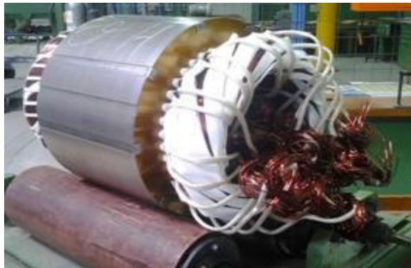
Figure I. 26 : Stator bobiné isolé
