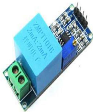
FIGURE II.9 : PHOTOGRAPHIE DU CAPTEUR DE TENSION, LE ZMPT101B [27]
