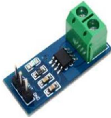
FIGURE II.6 : CAPTEUR DE COURANT ACS712
