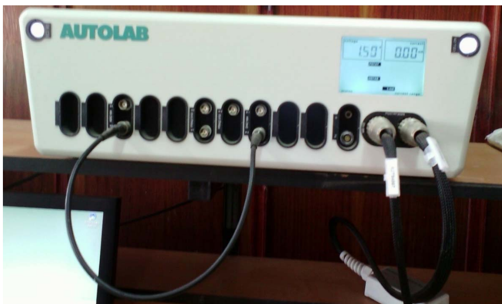
Figure II.1. Schéma de l'équipement électrochimique Autolab 302N
