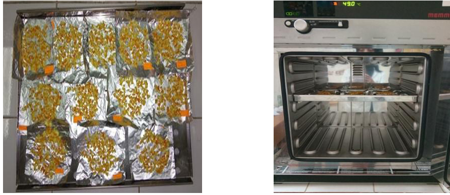
Figure 5: Etuvage des écorces d'orange en vue l'étude de la cinétique de séchage.
