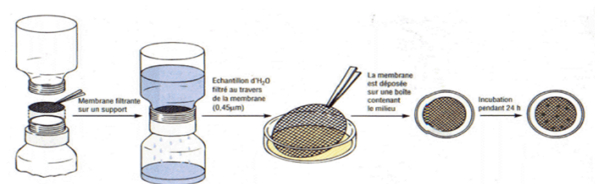
Figure 06 : Le contrôle de la contamination de l'eau par la filtration membranaire (Meex, 2018).
