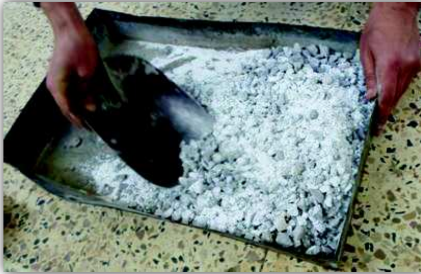
photo (IV.2) : malaxage des constituants (chaux+granulats)
