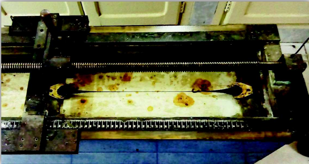
photo (III.5) : opération d'étirage
