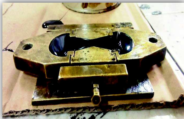
Photo (III.3) : remplissage de moule
