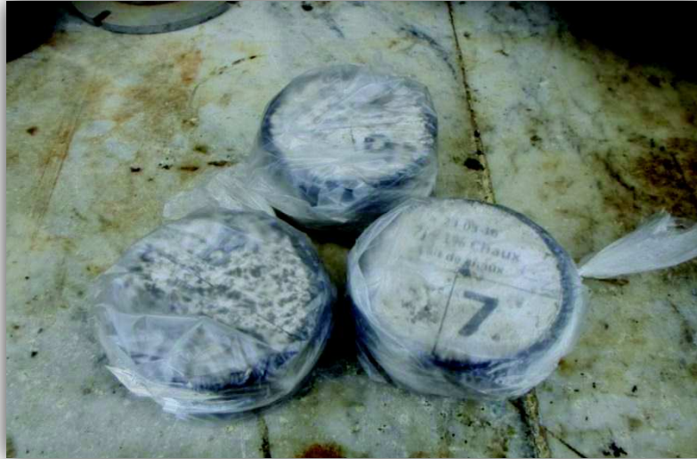
Photo (IV.17) : éprouvettes protégés avec un sac de plastique
