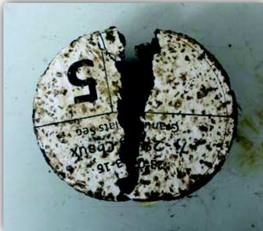
Photo(IV.20) : Type d'éprouvette écrasé par traction indirecte (fendage).
