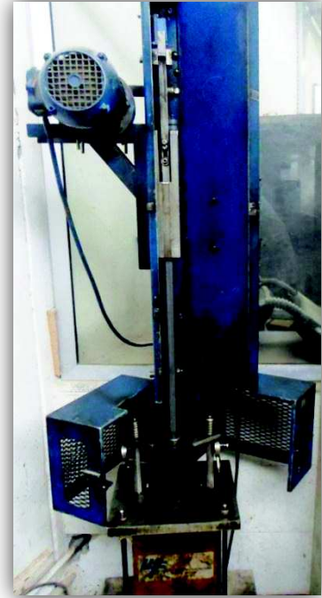
photo (IV.11) : L'opération de compactage
