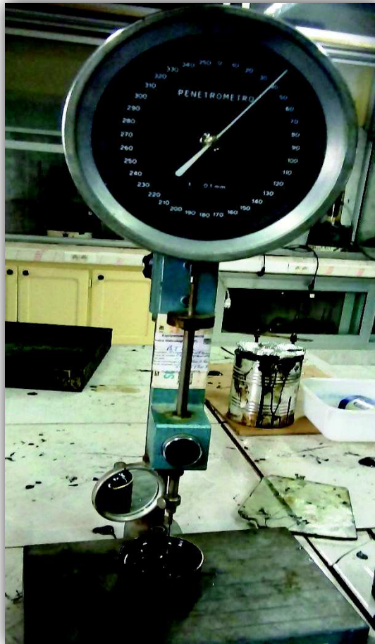
photo ( III.10) : mesurer la profondeur d'enfoncement
