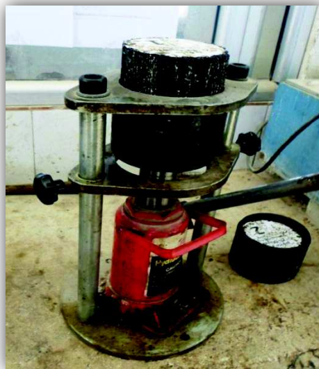
Photo (IV.12) : L'opération de démoulage
