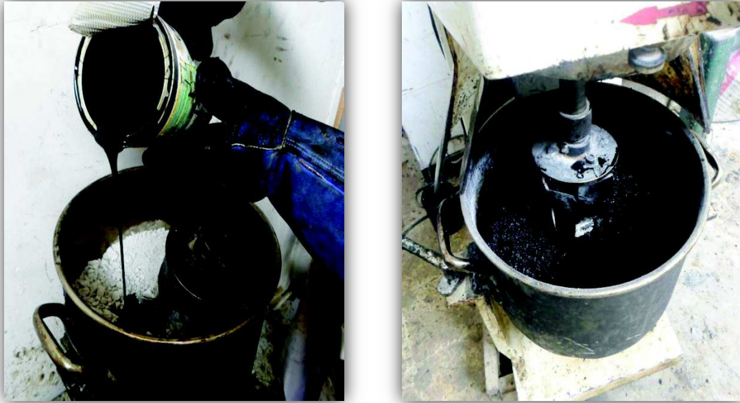
photo (IV.7) : L'opération de malaxage .
