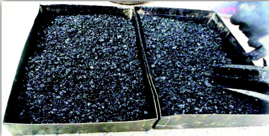
Photo (IV.8) : béton bitumineux obtenu après malaxage.
