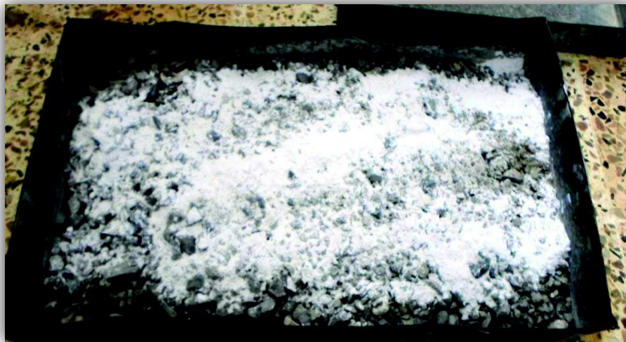
photo (IV.1) : granulats traitées par la chaux hydratée
