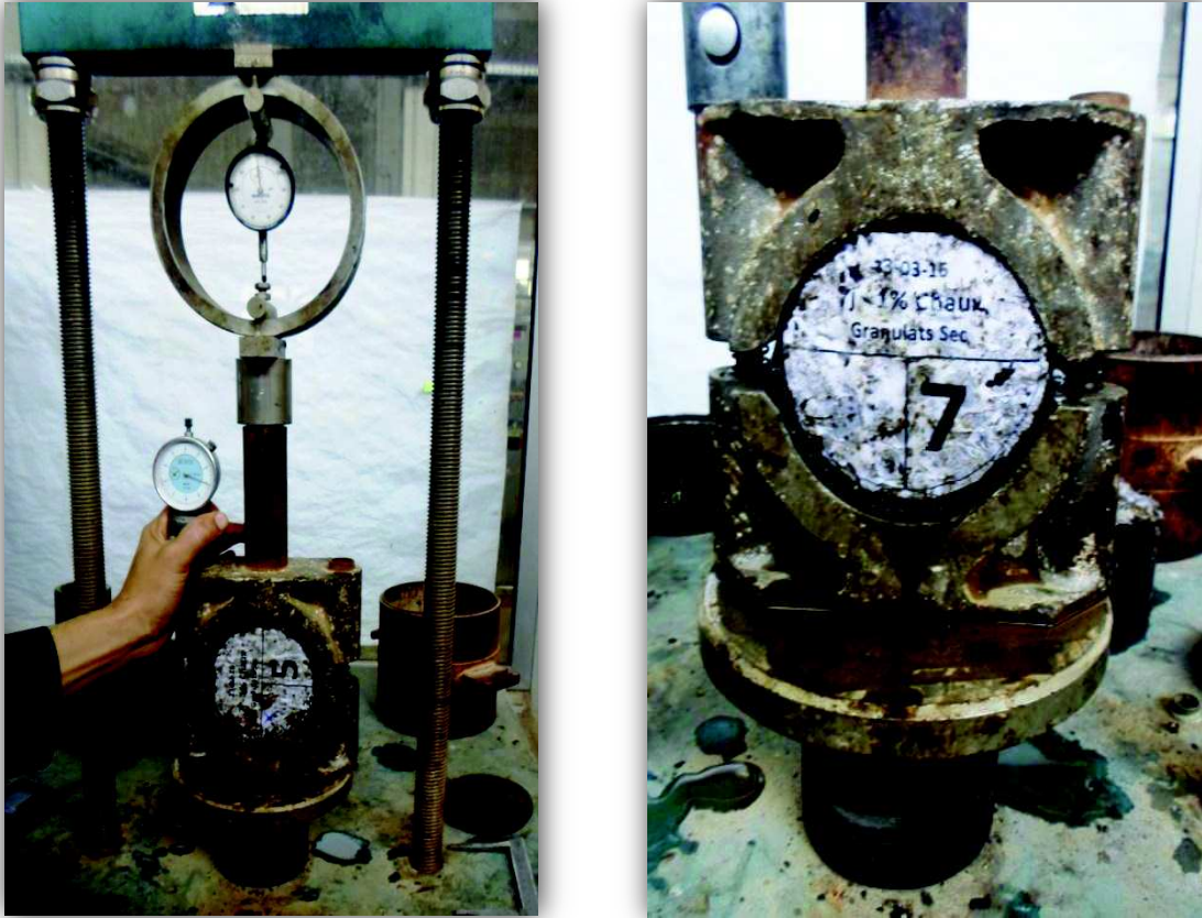
Photo (IV.14) : L'éprouvette dans les mâchoires
