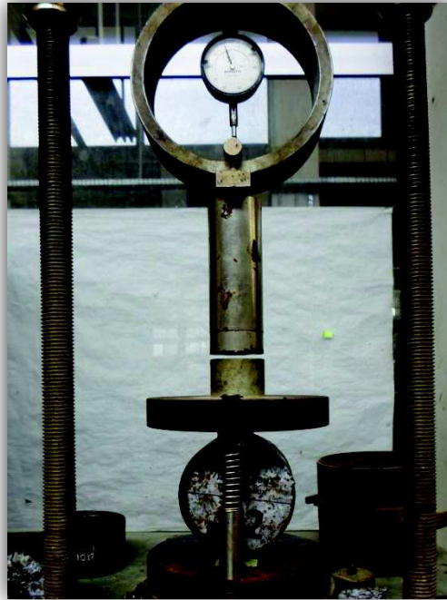
Photo (IV.19) : opération d'essai de traction indirecte
