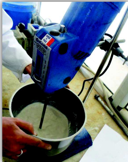
photo (IV.3) : préparation de lait de chaux
