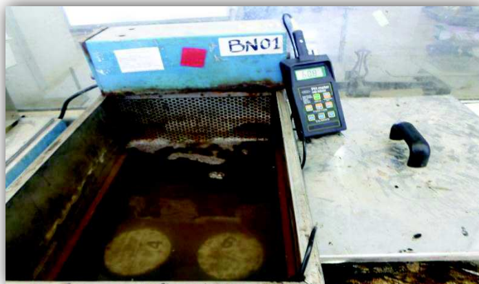
Photo (IV.13) : éprouvettes dans le bain thermostatique réglé à 60^{\circ}\text{C} \pm 0,5^{\circ}\text{C}
