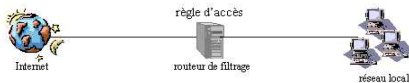
Figure 25 : Firewall avec routeur de filtrage.
