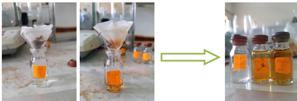
Figure IV .50 : élimination de gel de silice.
