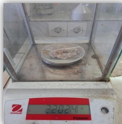
Figure. IV. 60: La pesée de la bentonite.
