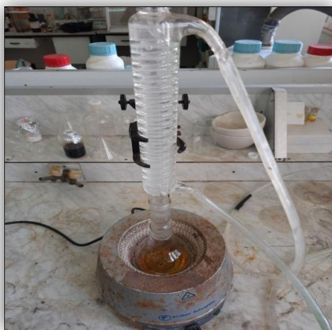
Figure IV.55 : Réchauffage de para-tert-butylphénol.
