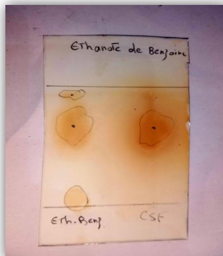
Figure IV.46: la chromatographie d'éthanoate de benzoïne.
