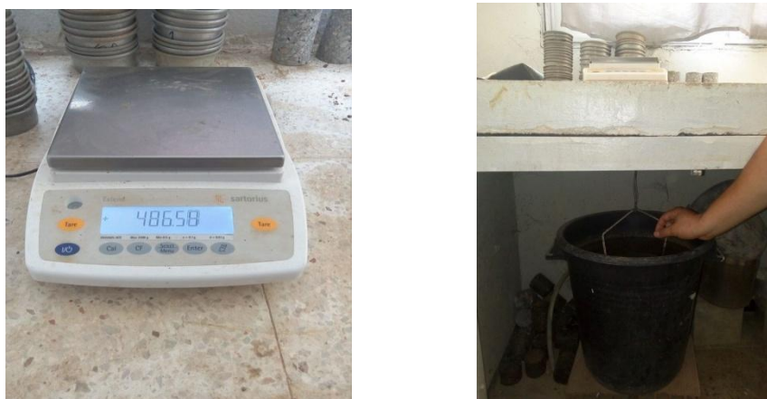
Figure IV.6 : Masse des briques saturés pesés dans l'eau (balance hydrostatique) ( M_a ).
