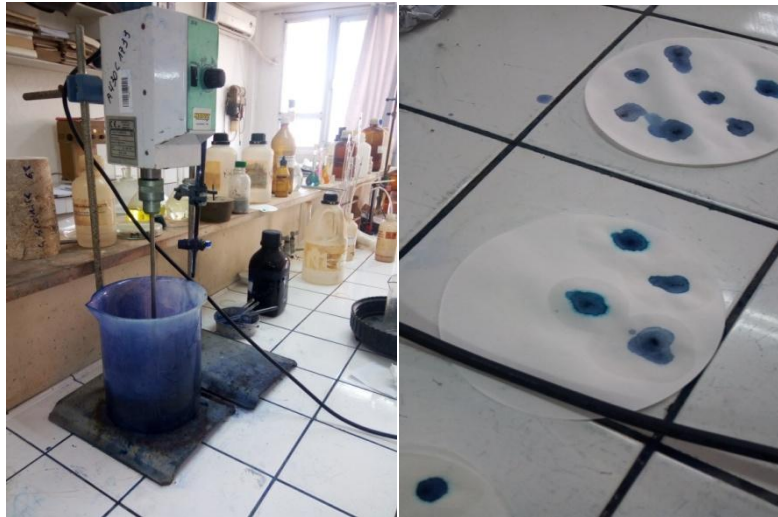
Figure III.3 : Essai pour déterminer la valeur de bleu de méthylène.
