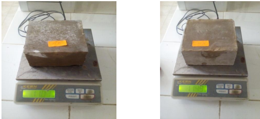
Figure IV.5 : Masse des briques obtenues après séchage à l'étuve ( M_{sec} ).
