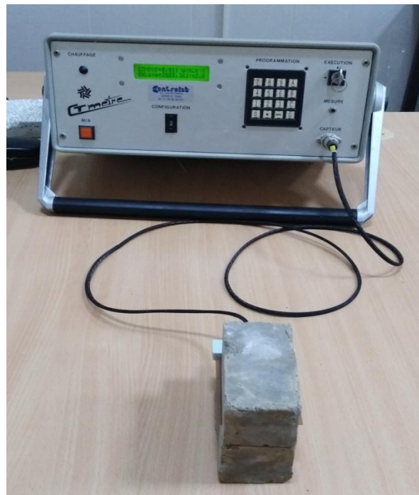
Figure IV.13 : Essai de CTMETRE de CNERIB
