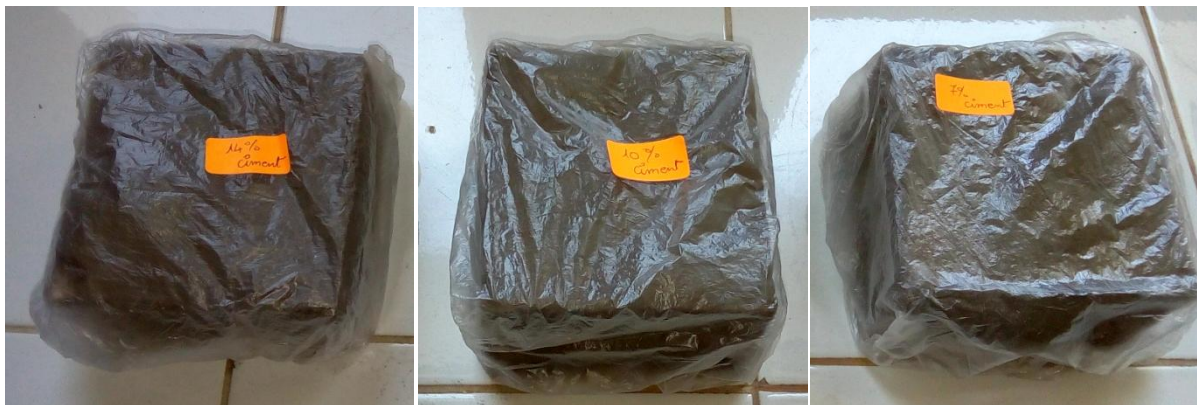
Figure III.19 : briques protégés avec du plastique pendant 20 jrs.
