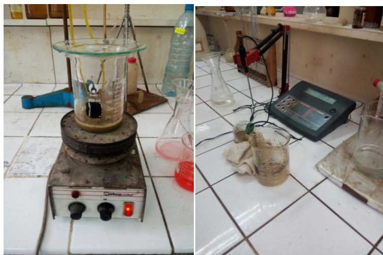
Figure III.4 : Essai pour déterminer la valeur de PH.
