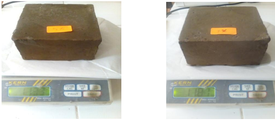
Figure IV.4 : masse des briques immergées dans l'eau ( M_{sat} ).
