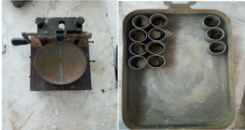
Figure III.2 : Essai pour déterminer la limite de plasticité et de liquidité.
