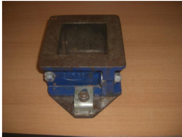
Figure III.13 : Le moule cubique utilisé pour la fabrication des briques.
