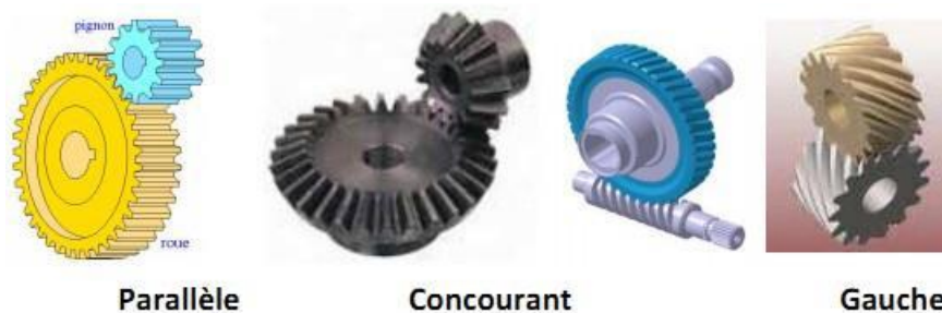
Figure III.10 Différents types des engrenages
