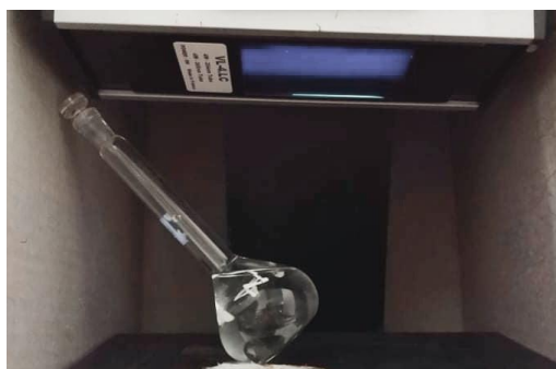
Figure B.1 : Solution de C 1 irradiée par la lampe UV à \lambda = 365 \text{ nm}
