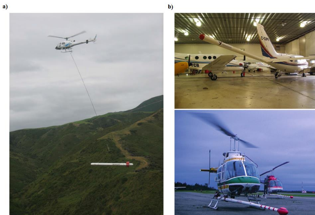
Figure 3.06 : Configuration du système de mesure magnétométrique. (a) Configuration en remorque oiseau (USGS), (b) Configuration en queue (Novatem)
