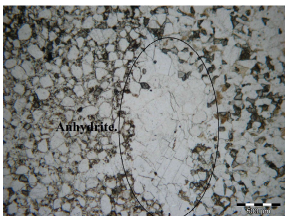
Photo 46 : côte: 2848.06m X2 LN Ciment évaporitique (anhydrite).
