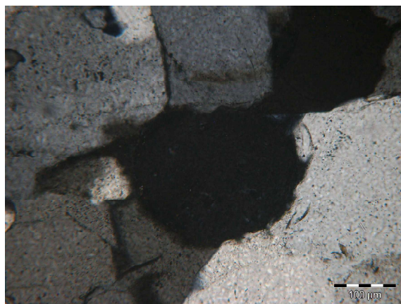
Photo 28 : côte: 2774.2m X10 LP Porosité de dissolution.
