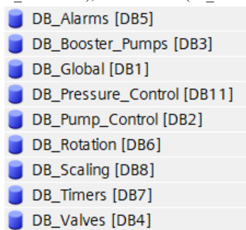
Figure 20. Data Block dans Tia Portal
