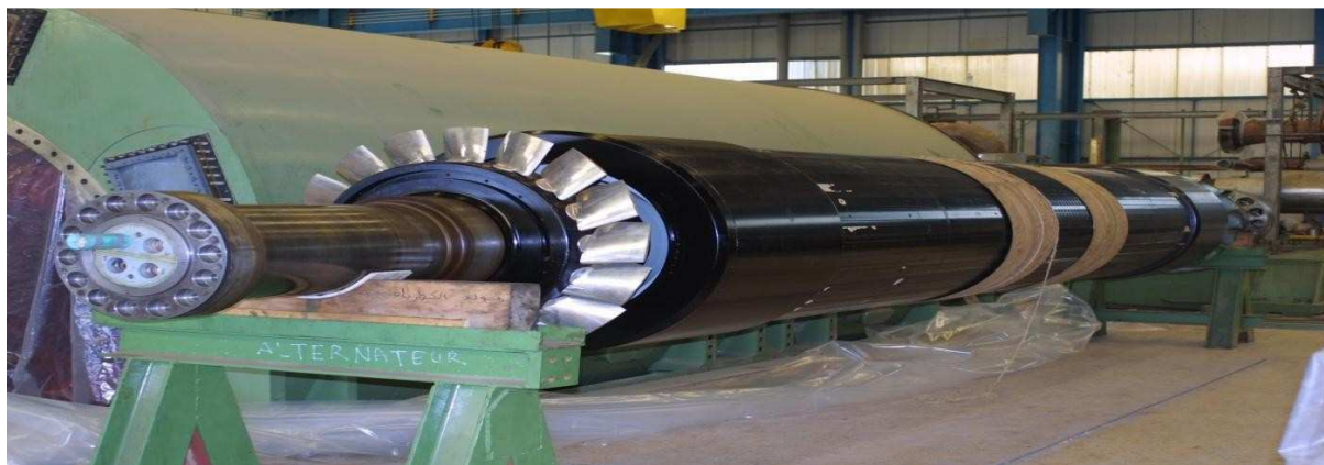
Fig.I.5 : partie mobile de la machine (l'inducteur).
