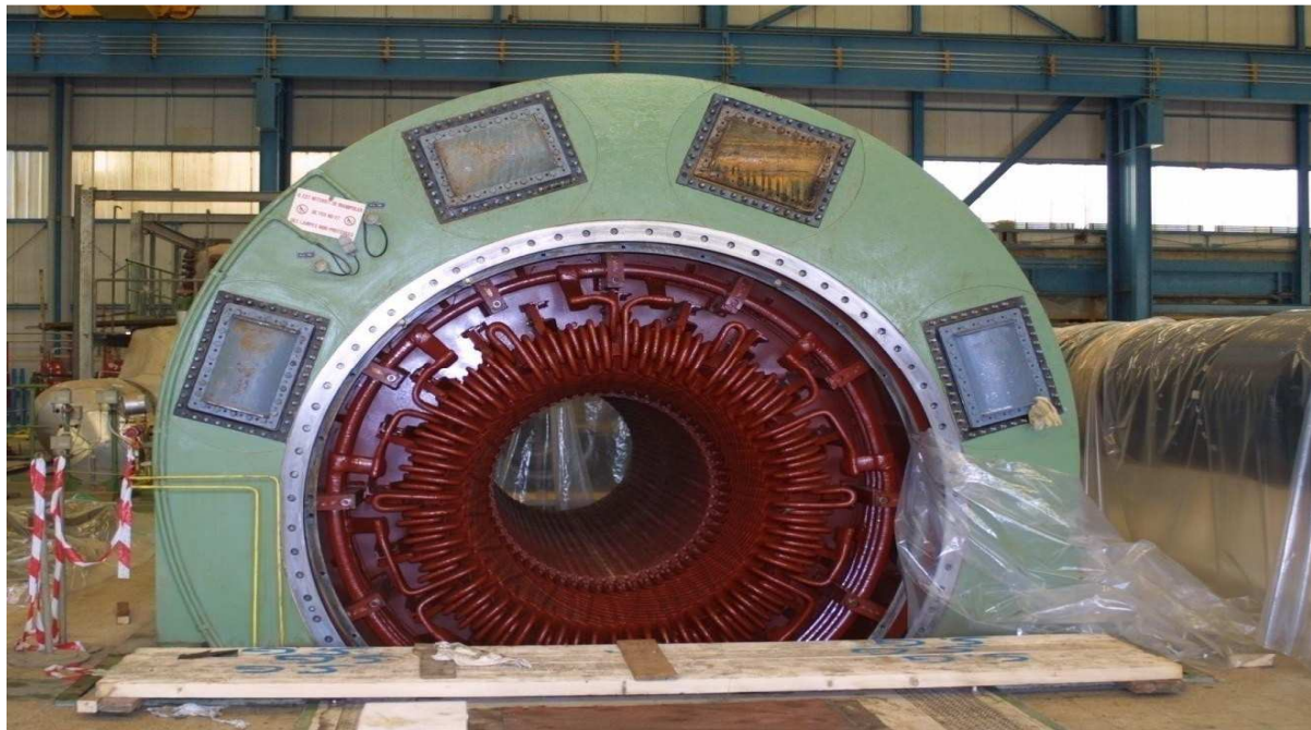
Fig.I.6 : partie fixe de l'alternateur (l'induit).
