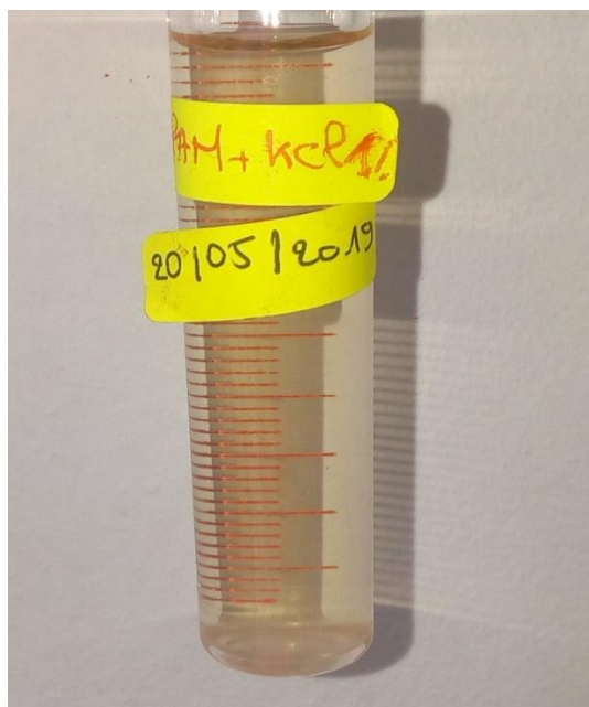
Figure V-24 : après 48h à 110°C (changement de couleur du transparent vers le brunâtre dû à la présence des ions de \text{Na}^+ et \text{K}^+ dans la solution ainsi que l'effet de la température élevée).
