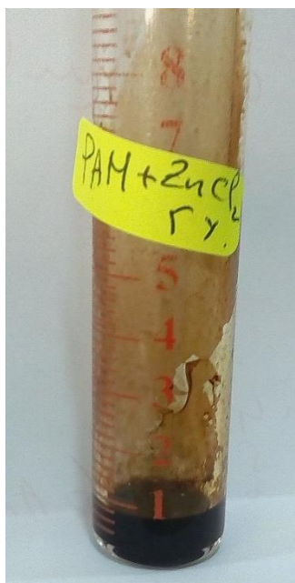
Figure V-28 : après 48h à 150°C : la solution de polymère devient opaque à cause de la température élevée
