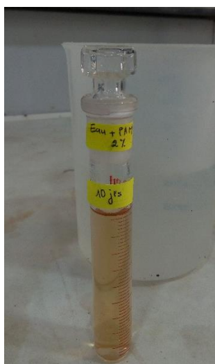
Figure V-21 : après 24h dans l'étuve à 110°C (changement de couleur du transparent vers le marron clair et cela dû à L'augmentation de la température)
