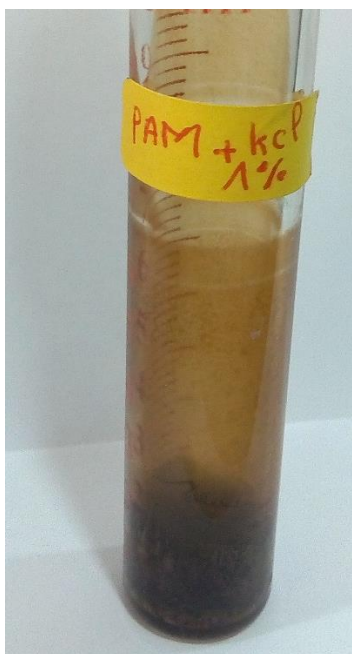
Figure V-25 : après 72h dans l'étuve à 150°C (évaporation totale de l'eau+ précipitation du polymère avec une opacité du couleur)
