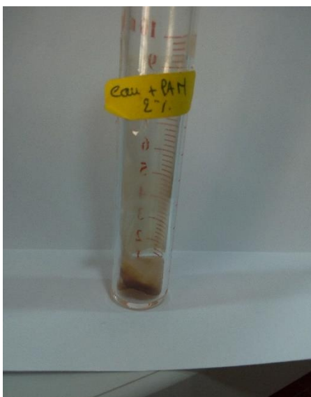
Figure V-22 : après 72h dans l'étuve à 150°C (Évaporation totale de l'eau+ précipitation Du polymère avec une couleur opaque).
