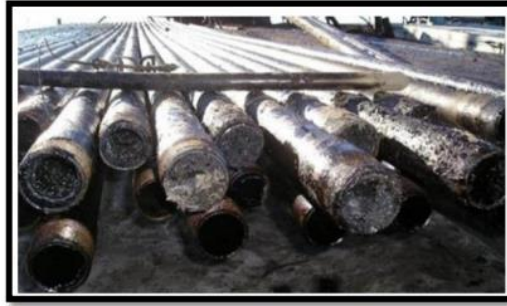
Figure II.5 : Dépôt d'asphaltène dans les tubings de production
