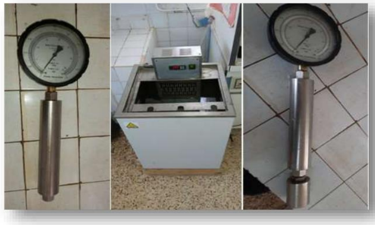
Figure I.2: Bombe pour la mesure de la tension de vapeur [2].
