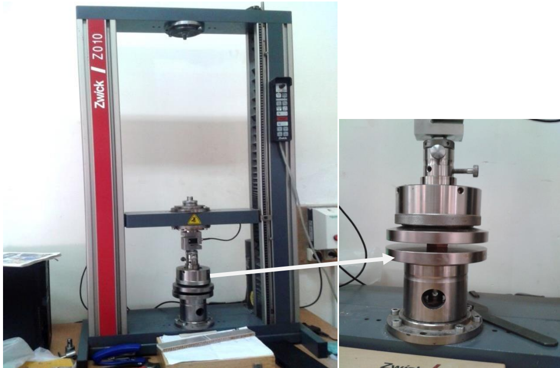
Figure 35 : Machine d'essai universel de compression (ZWICK-Z010)
