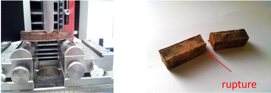
Figure 48 : Illustration de la flexion d'éprouvette de géopolymère de base
