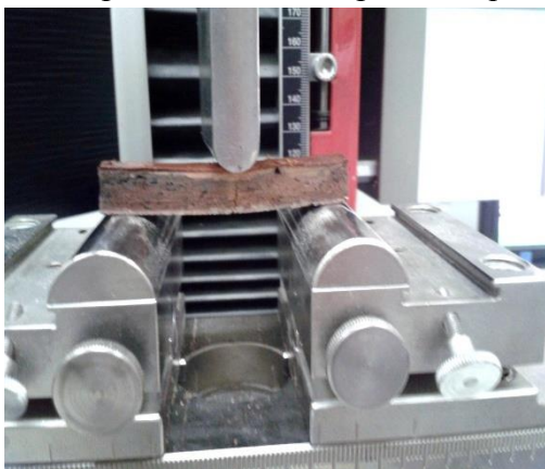
Figure 47 : Illustration de flexion de l'éprouvette de composite
