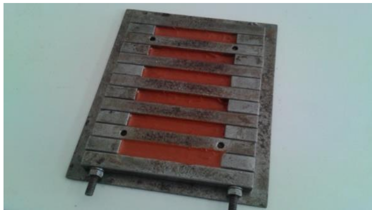
Figure 27 : Image du remplissage de moule par la pâte de géopolymère
