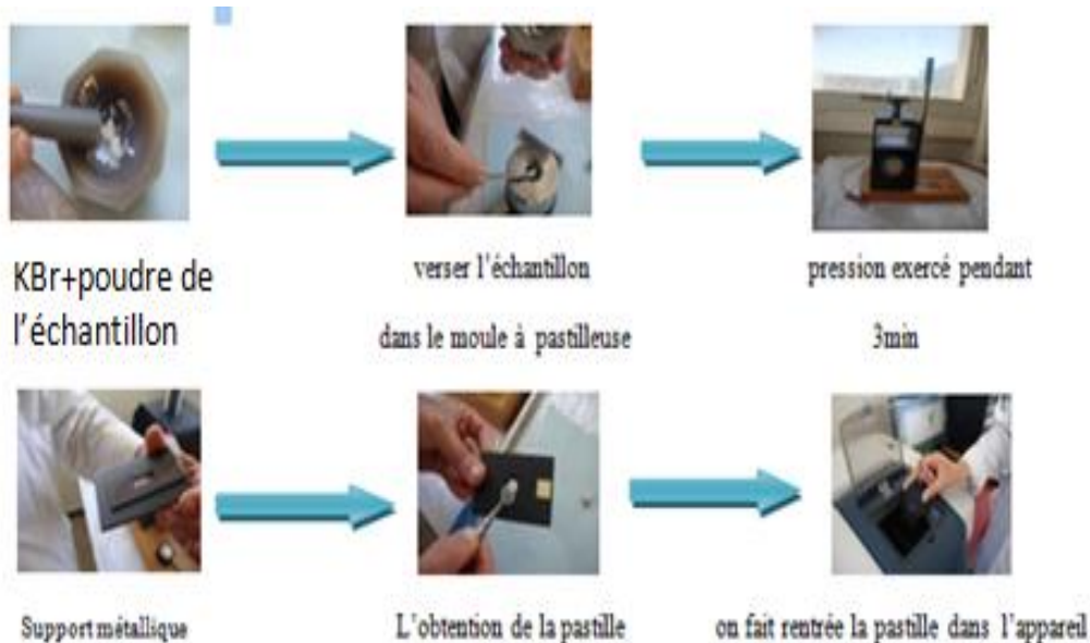
Figure 34 : Schéma pour l'obtention de la pastille
