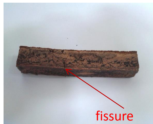
Figure 47 : Illustration de flexion de l'éprouvette de composite
