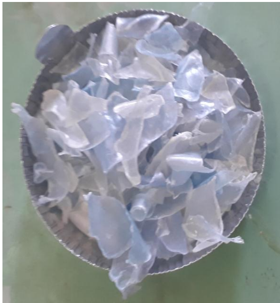
(c) Déchets de bouteilles transparentes et bleues broyées et traitées avec NaOH puis rincées jusqu'à le PH = 7
