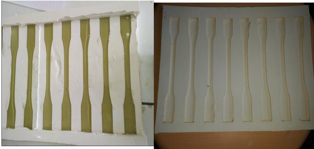
Figure 7 : Moule normalisé utilisé pour fabriquer les éprouvettes pour le test de traction et flexion.
