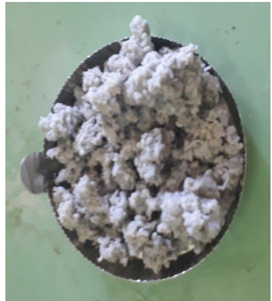
(d) Déchets en PET cumulés à la sortie de la filière de l'extrudeuse et broyés (gris bleuâtre)
