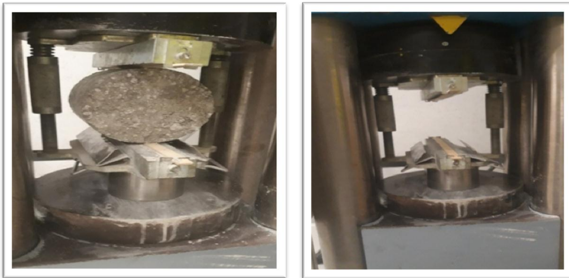
Figure III.24. Eprouvette soumise à l'essai de fendage.
