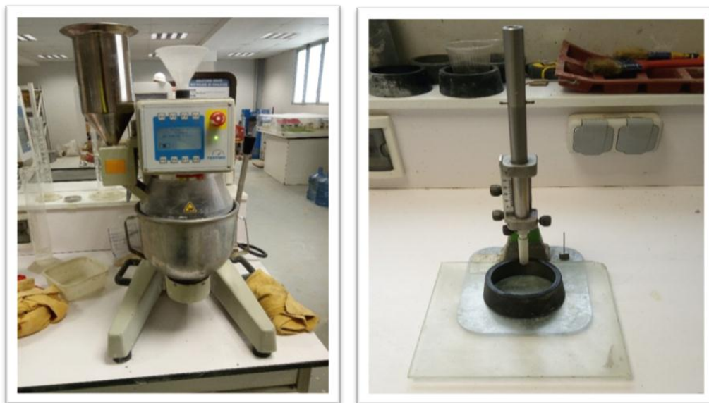
Figure III.12. Malaxeur normalisé et appareil de vicat muni de sa sonde de consistance.
