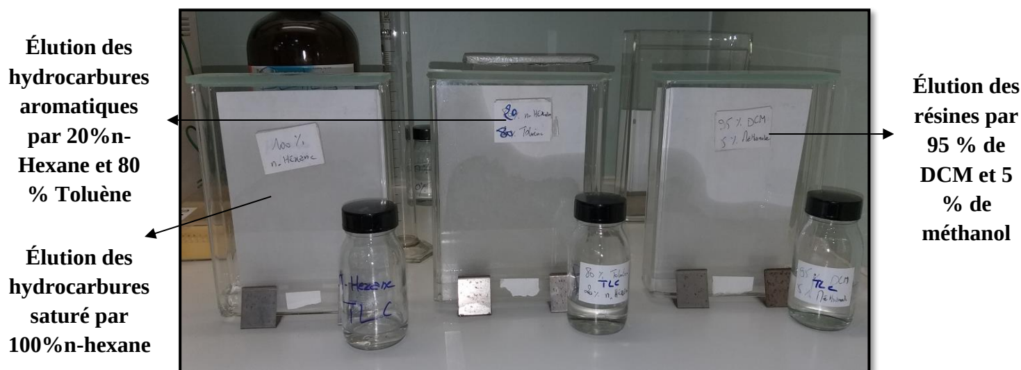
Fig.III.9 : Séparation de constitués d'hydrocarbures par TLC.
