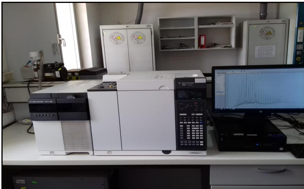
Fig III.16. Chromatographie en phase gazeuse couplée a la spectrométrie de la masse Protocole d'analyse par GC/MS :
