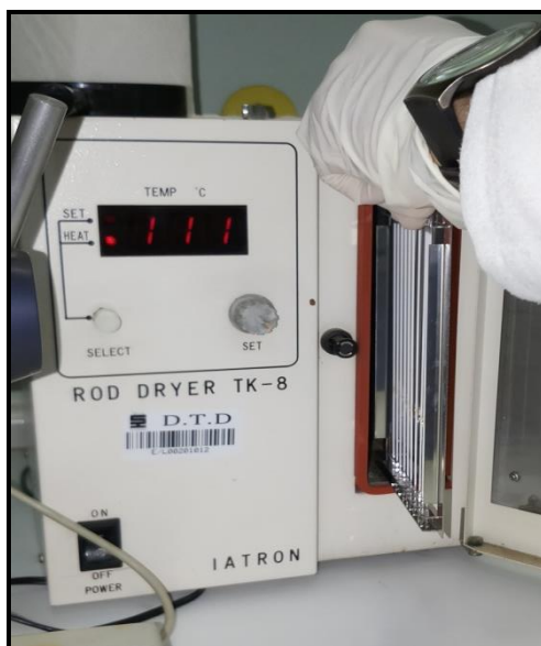
Fig.III.11 : Four pour évaporé le solvant
