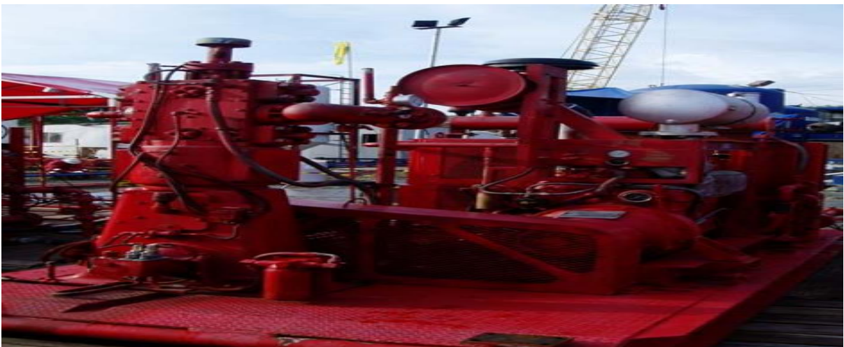
Figure III.6 : WB-11 Surpresseur haute pression (4000 psi)
