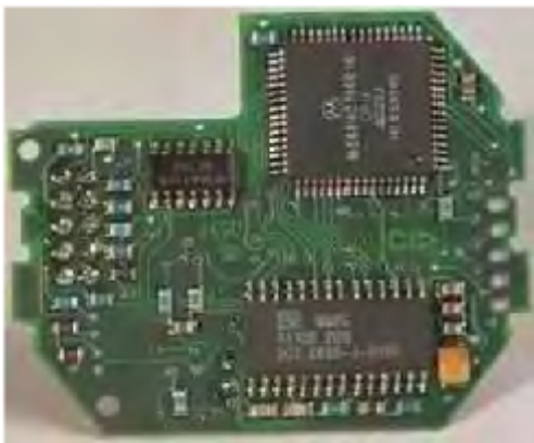
Fig. II.14. Circuit d'une unité BCU
