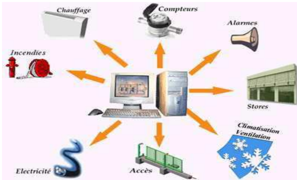
Figure I .4 : La Gestion technique d'un bâtiment intelligent
