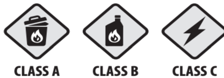
Figure II.2 : Classes de feu compatibles avec le NOVEC 1230
