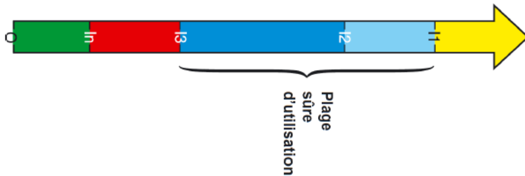
Fig. II.21 - Les zones de fonctionnement des fusibles HTA.
