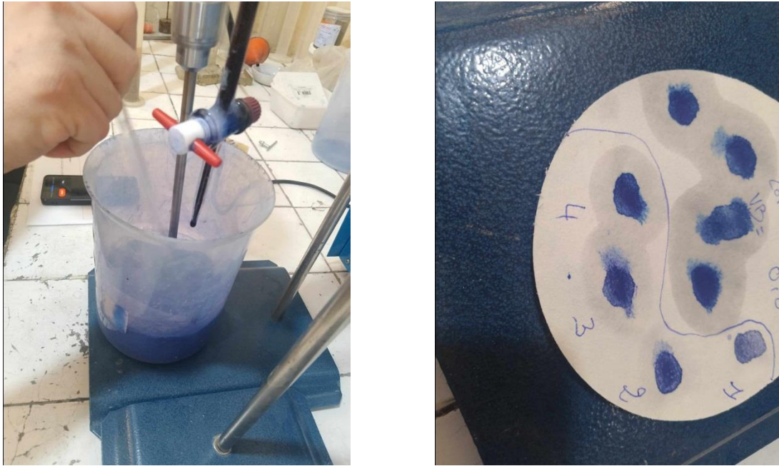
Figure V.3 : Essai au bleu de méthylène.
