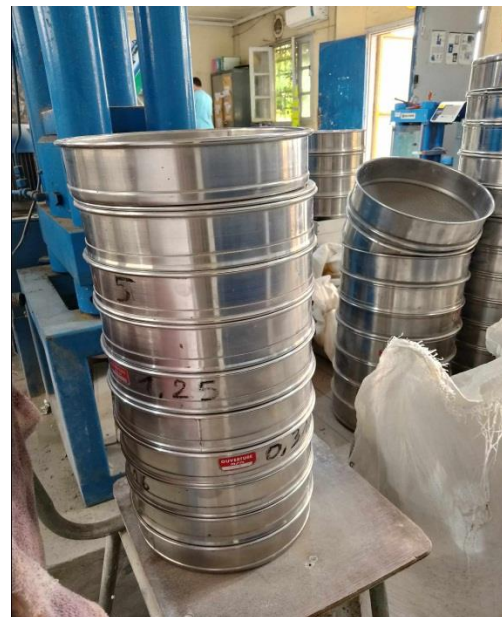
Figure V.1 : Essai d'analyse granulométrique
