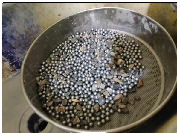
Figure V.7 : Essai de Micro Deval
