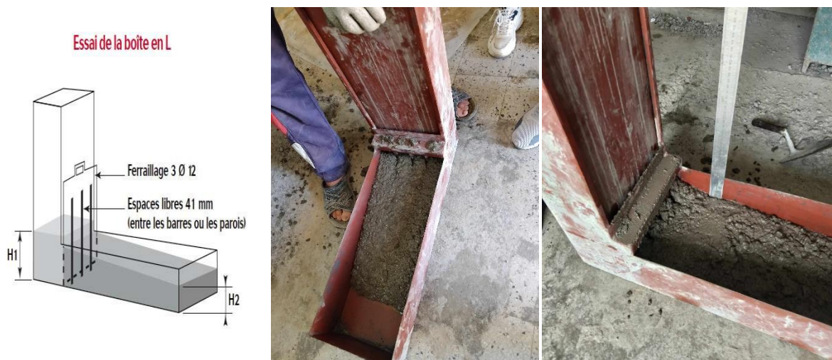
Figure III.3 : Essai de boîte en L
