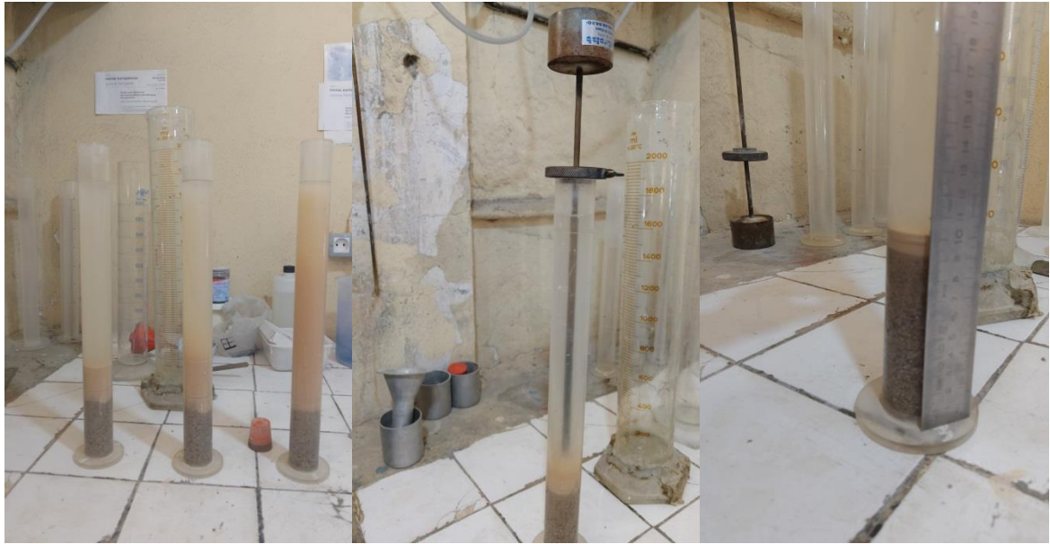
Figure V.2 : Essai d'équivalent de sable
