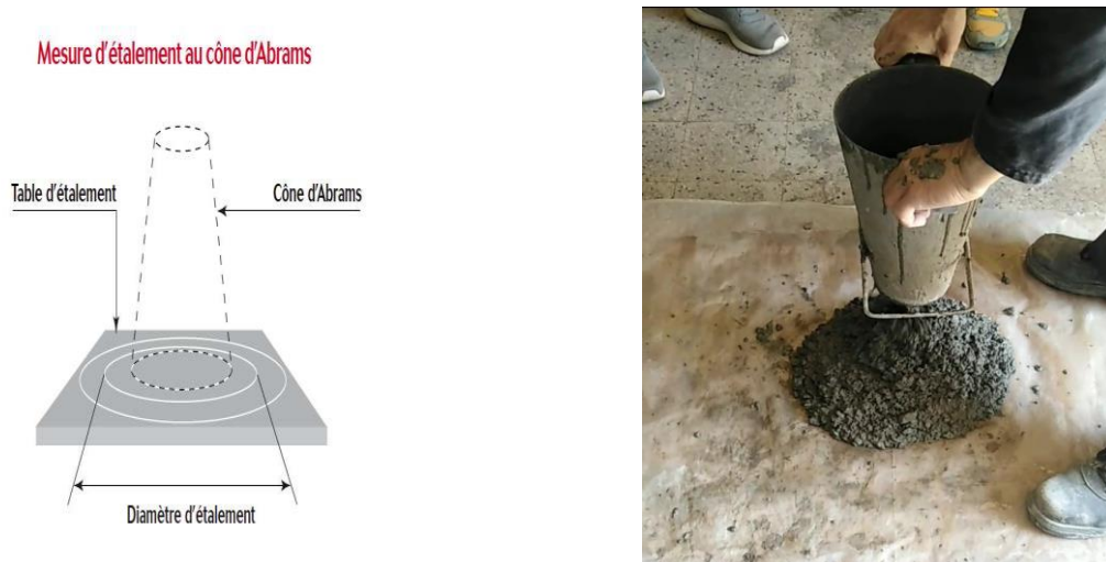
Figure III.1 : Essai d'étalement pour béton témoin
