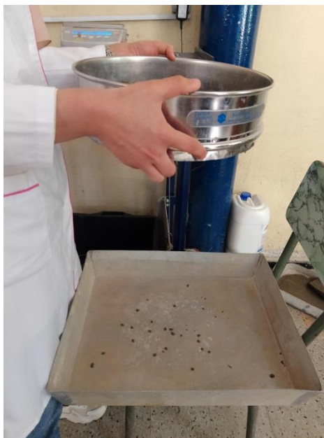
Figure V.10 : Essai de stabilité au tamis.
