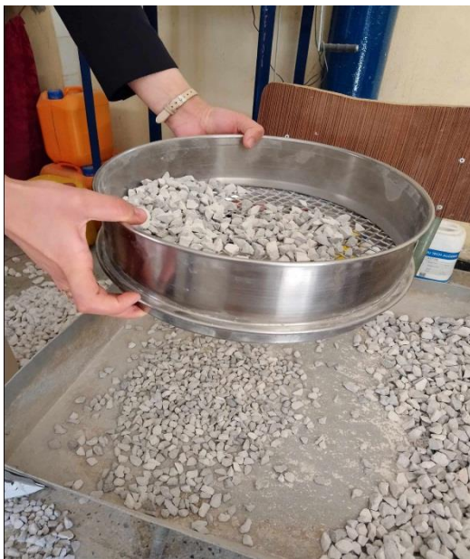
Figure V.1 : Essai d'analyse granulométrique
