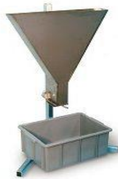
Figure III.2 : Essai d'entonnoir en V
