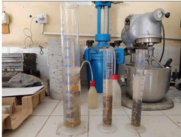
Figure V.4 : Essai pour déterminer la masse volumique
