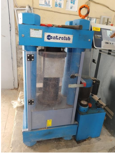
Figure V.11 : Essai de la résistance à la compression.
