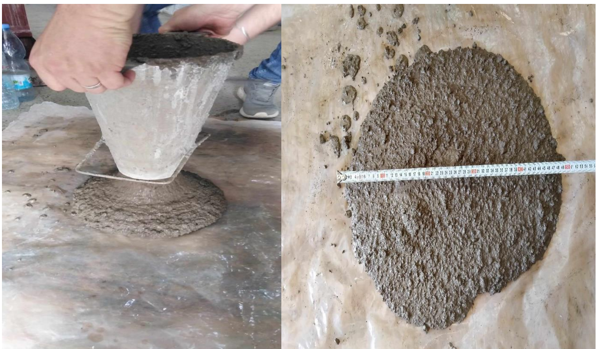
Figure V.8 : Essai de l'étalement
