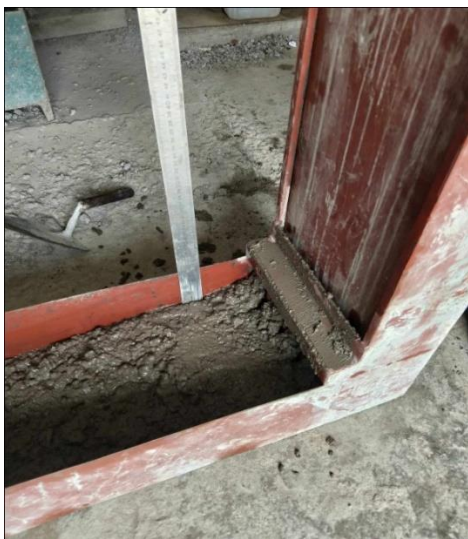
Figure V.9 : Essai de la boîte en L.
