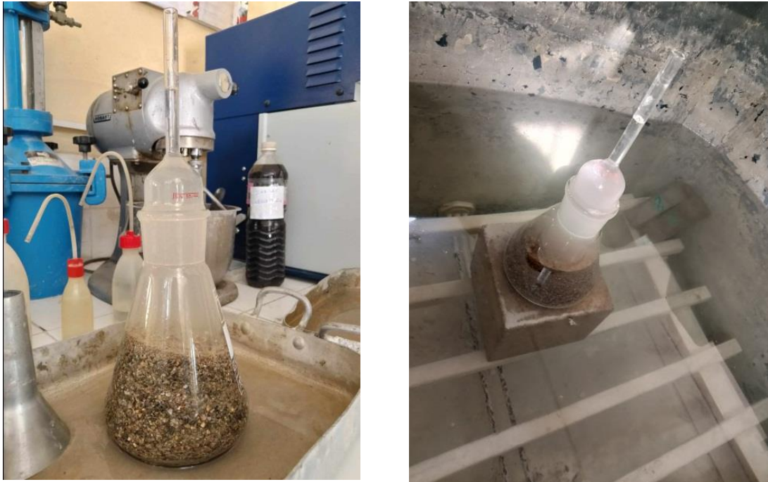
Figure V.5 : Essai pour déterminer l'absorption d'eau
