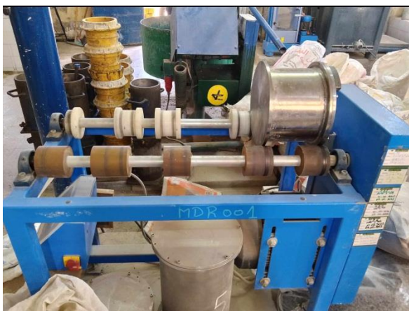
Figure V.7 : Essai de Micro Deval
