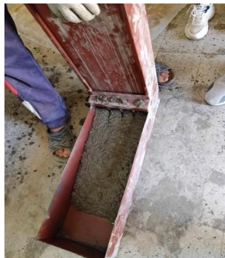
Figure V.9 : Essai de la boîte en L.
