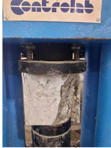
Figure V.11 : Essai de la résistance à la compression.
