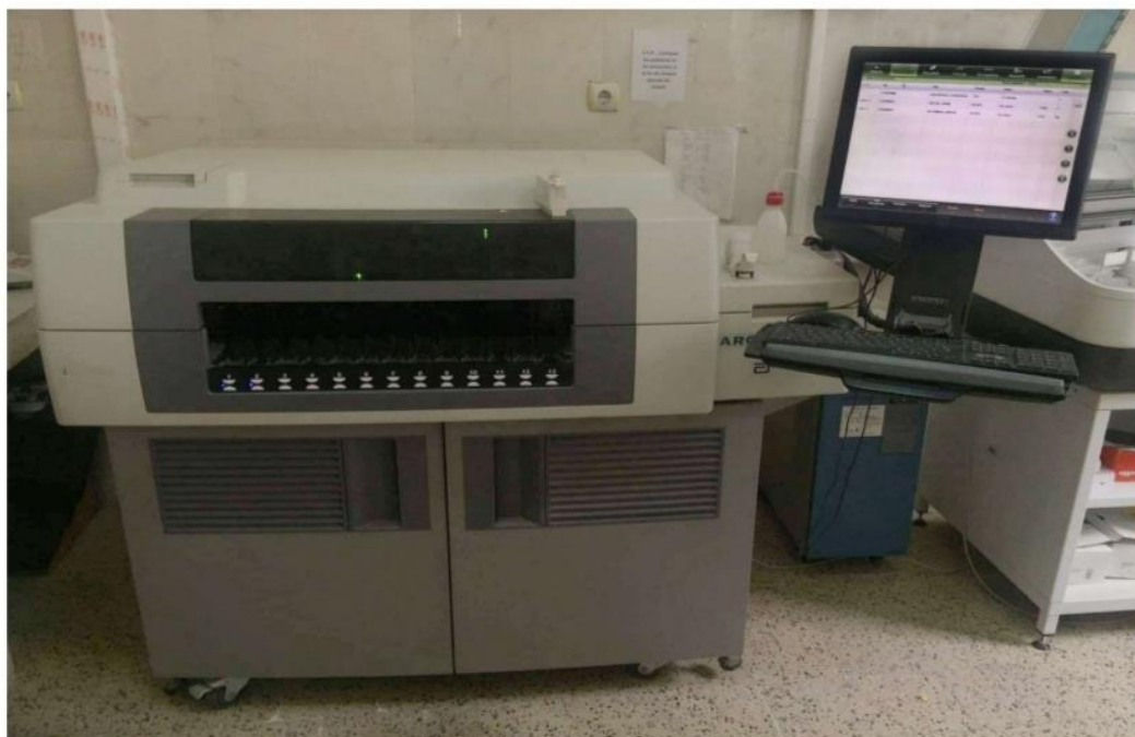
Figure 22: Automate Abbot® Architect ci4100 utilisé pour l'analyse du CA19-9.
