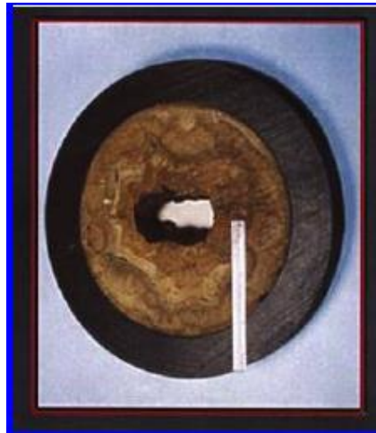
Figure 1.2 : Pipeline bouché par dépôt de paraffine (Zhenyu Huang et al. (2015)).
