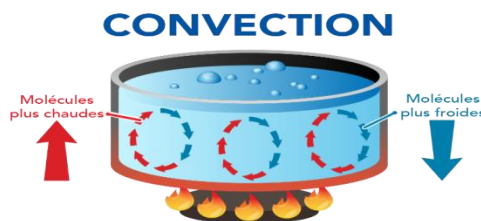
Figure 1.8 : Transfert de chaleur par convection.
