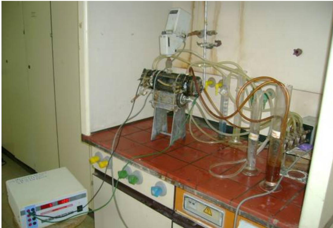
Figure III-2: Photo de la cellule du procédé électrochimique en fonctionnement.
