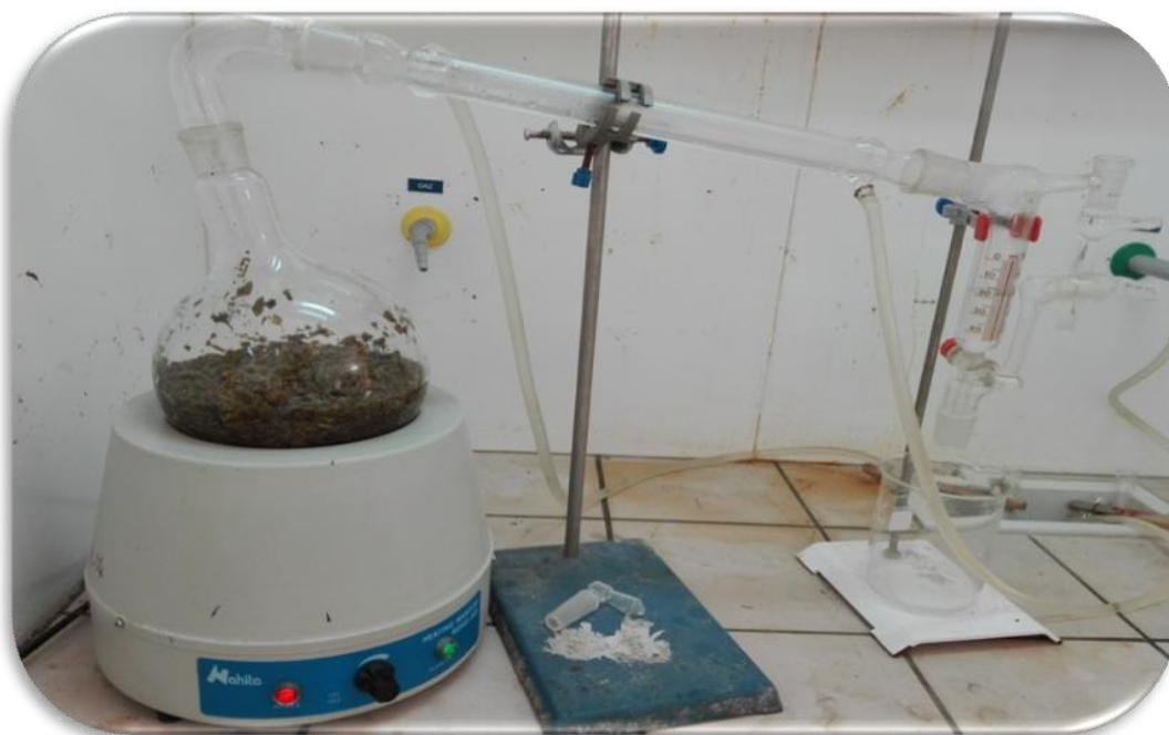
Figure 12: Dispositif de l'hydrodistillation à l'échelle de laboratoire
