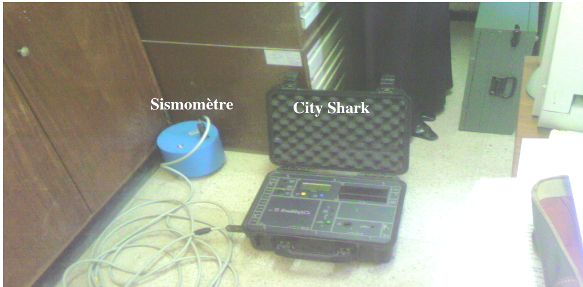
FigureVII. 3 : Matériels d'enregistrements (sismomètre et Cityshark).
