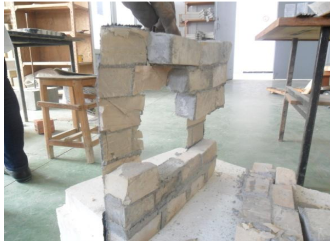
Figure IV.21 : arrachement d'interface renfort
