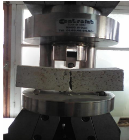
Figure III.9 : rupture de mortier par flexion
