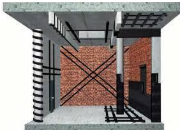
Figure II.6 .Renforcement par fibres de carbone de divers éléments structuraux (Éléments en béton armé et maçonnerie)
