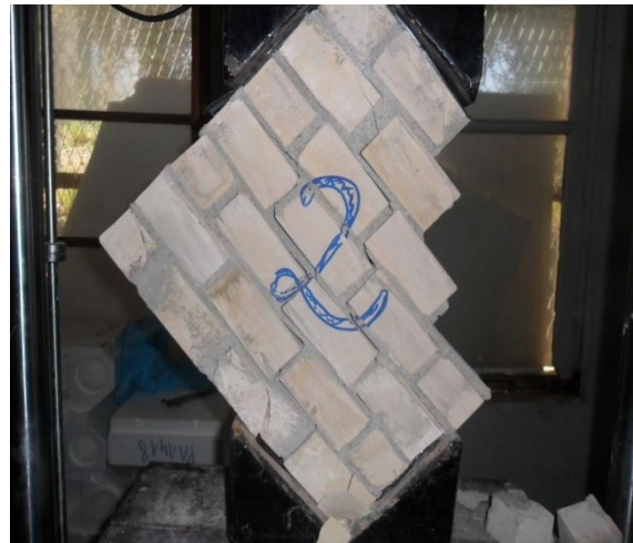
Figure IV.8: mode de rupture de muret témoin
