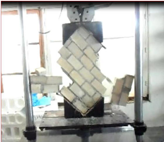
Figure IV.7: mode de rupture de muret témoin
