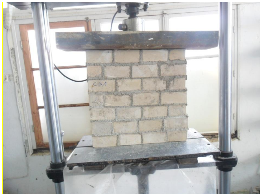
Figure IV.1: Essai de compression uni-axiale (vérin de 100 KN)
