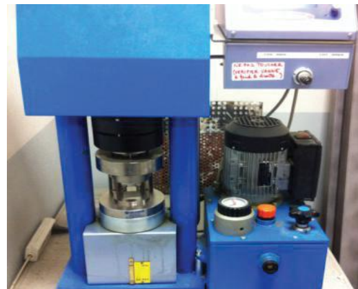
Figure III.6 : Machine d'essai de compression
