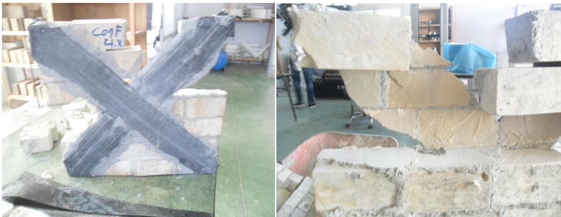
Figure IV.26: arrachement entre la pierre et la fibre CONF 4.2
