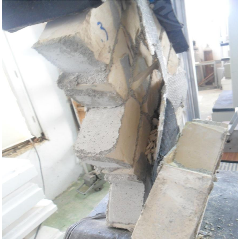
Figure IV.28: Arrachement entre la pierre et la fibre CONF4.3
