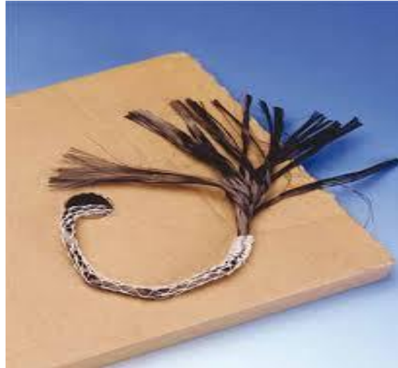
Figure II.5 : Fibre constituée de filaments
