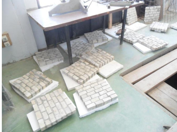
Figure III.29 : murets finis prêts à l'écrasement
