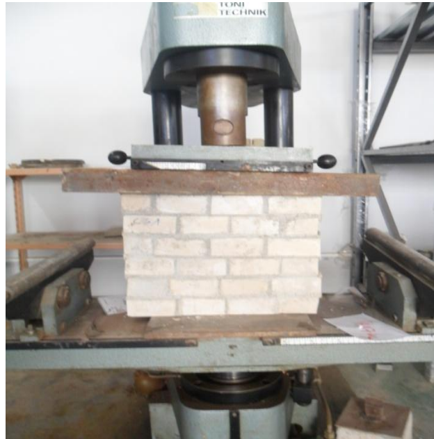
Figure IV.2: Essai de compression uni-axiale (vérin de 200 KN)
