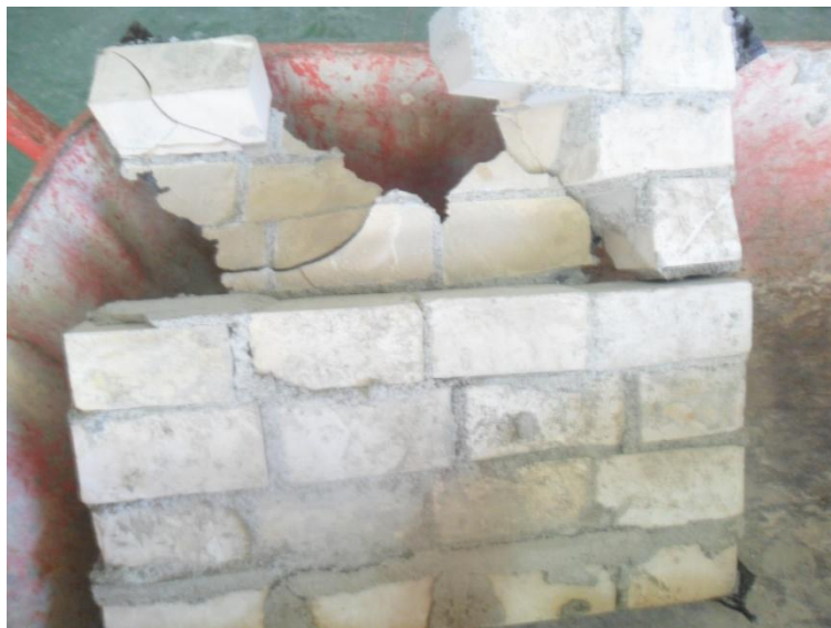
Figure IV.24: arrachement entre la pierre et la fibre CONF 4.1
