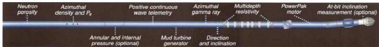
Figure 19 : Les différents étages d'un MWD
