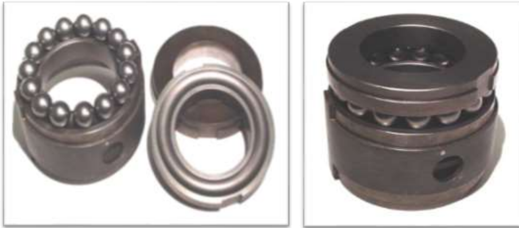
Figure 9 : Roulement d'un PDM (à billes)
