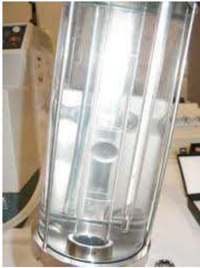
Figure II.13 : Appareillage du viscosimètre à chute de bille.
