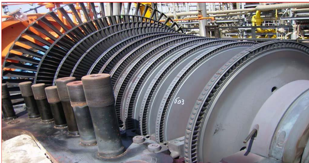
Figure 1.5 Rotor d'une turbine à vapeur MHI
