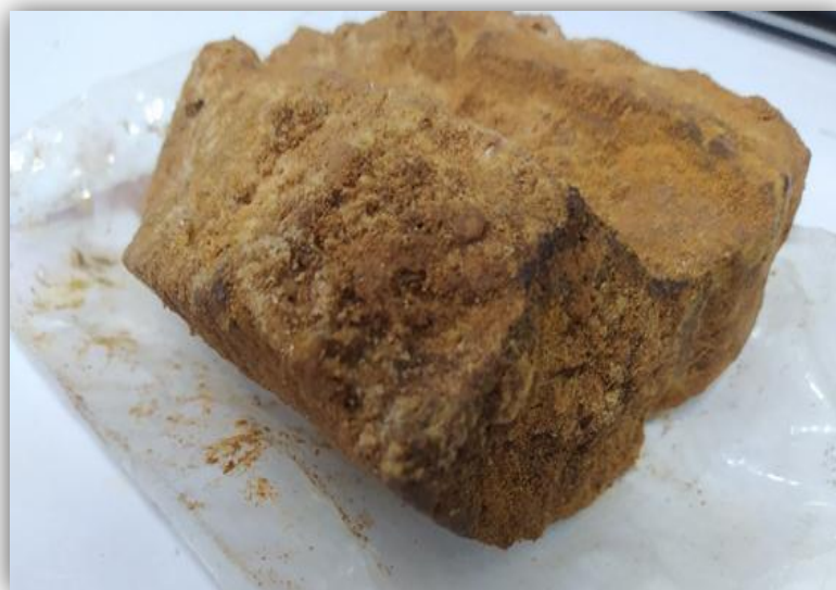
Figure 10 : Dépôt récupéré au niveau de manifold A1 champ STAII.
