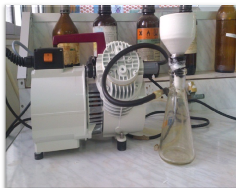
Figure 21 : L'installation de filtration
