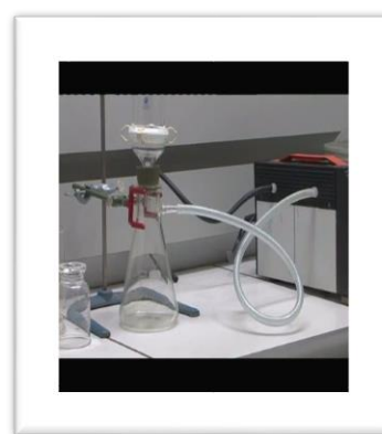
montage filtration sous vide
