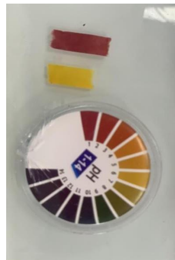
Figure II.12 : PH avant et après neutralisation
