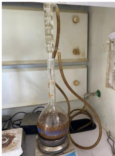
Figure II.04 : Chauffage à reflux en milieu acide
