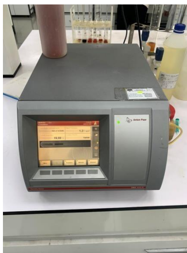
Figure II.10 : Mesure de Brix par DMA.
