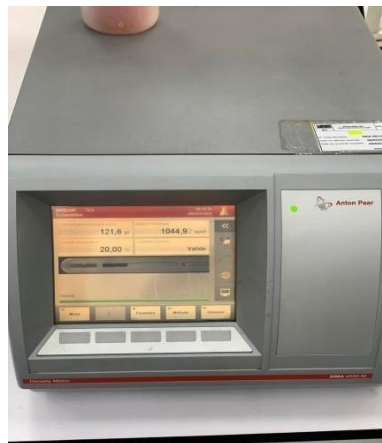
Figure II.16 : Densimètre DMA 4500M
