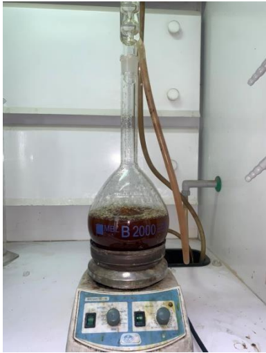
Figure II.05 : Chauffage a reflux en milieu basique
