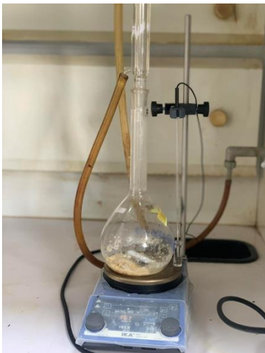
Figure II.08 : hydrolyse de la cellulose en milieu acide
