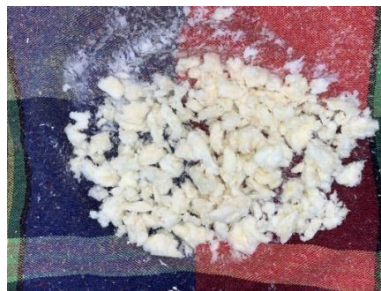
Figure II.07 : Cellulose après traitement à l'eau de javel
