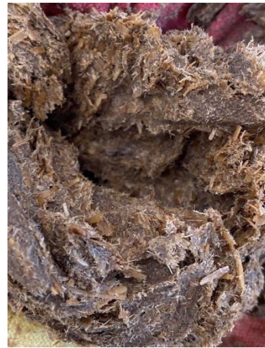
Figure II.06 : Paille après traitement en milieu basique
