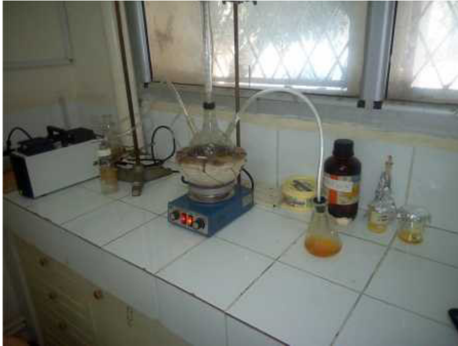
Figure 10 : Dispositif (de laboratoire) d'étude de la stabilité de l'huile de soja brute et raffinée
