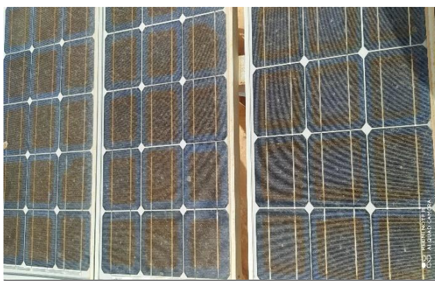
Figure III .1. Décoloration des cellules PV en marron ou jaune (URAER)
