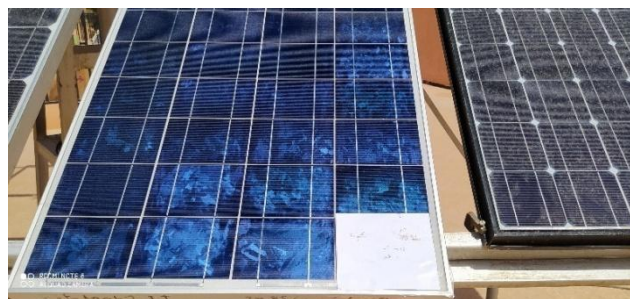
Figure III.7 : défaut d'ombrage d'une cellule
